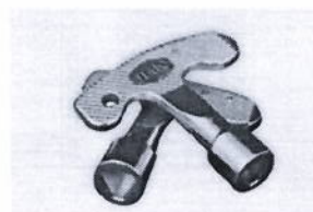
Ejemplo de llaves especiales de cuadros eléctricos
